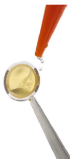
Figura 5. Illustrazione di come lavare il sensore evitando di ri-contaminare il sensore con la punta delle pinzette.
